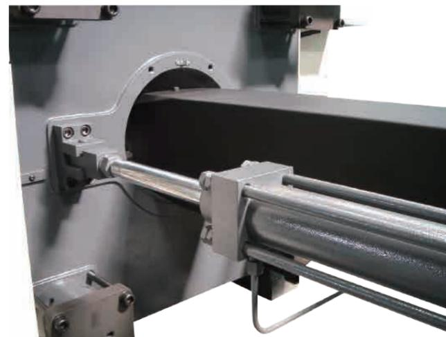
Конструкция узла впрыска с применением двух гидроцилиндров, расположенных в одной плоскости с осью материального цилиндра, обеспечивает высокую точность центрирования сопла и высокую плавность движения без перекосов при упоре сопла в литниковую втулку.
